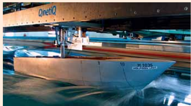
Tanktest: das Drettmann-Modell im Becken der Wolfson Unit.
