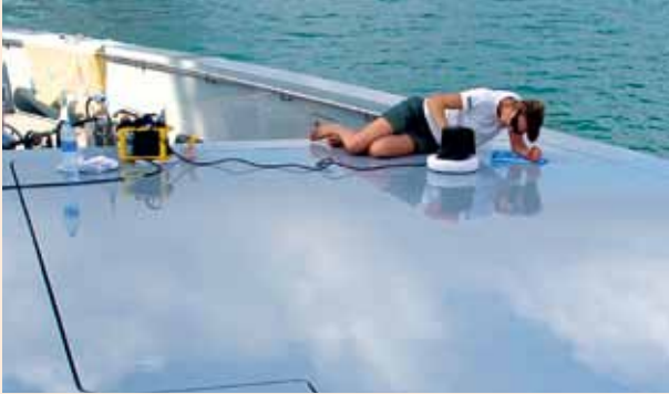
„Diamonding“: Die NobelClean-Crew beim Polieren von „Skat“. Nach der Lackreinigung folgt die Versiegelung.
